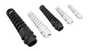
La tecnica applicata, combinata con una spirale flessibile antipiega, offre la protezione ottimale contro la rottura delle anime per i cavi di allacciamento mobili. In caso di pareti di grande spessore nelle morsettiere e nelle scatole di distribuzione, sono necessarie filettature di raccordo lunghe se nei fori non è presente alcuna filettatura. Con un controdado, questo pressacavo è adatto a pareti di spessore fino a 10 mm.
